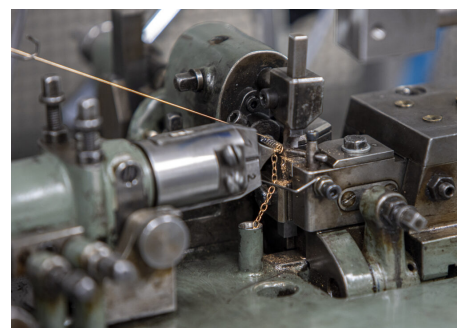
Die Kettenmaschine biegt und formt die einzelnen Kettenglieder. Foto: Thomas Meyer, Pforzheimer Zeitung
